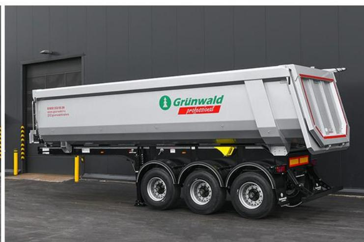
Специализированный самосвальный кузов для перевозки инертных сыпучих грузов и иных грузов пригодных для выгрузки посредством опрокидывания кузова.
